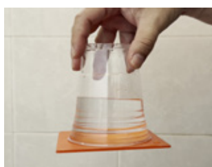
ขั้นตอนที่ 4 แผ่นพลาสติกจะติดอยู่ที่ปากแก้ว และน้ำจะอยู่เหนือแผ่นพลาสติกไม่ไหลออกมา
