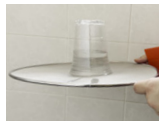
ขั้นตอนที่ 4 จากนั้นค่อย ๆ เลื่อน แผ่นพลาสติกออก จะพบว่าน้ำ ข้างในแก้วไม่ไหลผ่านรูกระชอน
